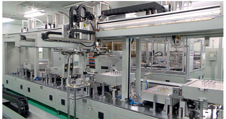
2 | Fertigungsstraße: VIA Optronics verwendet für das optische Bonding den selbstentwickelten und patentierten MaxVU-Prozess, bei dem das Silikon flüssig appliziert wird
